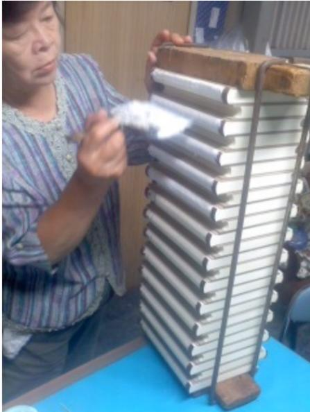
背中に丸みを持たせる事を丸背と言います、背中の丸みを出し、スピンをつけて、ヘドパンつけて、背固めをしている様子です。最近では全自動の上製本ラインとかあって（ドイツ製のコルプス社とかが有名）大量生産系は大手の製本屋がチャッチャカチャッチャカ作成しています。うちは刷毛を使って職人が1冊ずつ丁寧に糊入れをしています。
