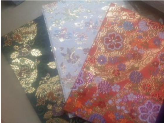
金欄生地を裏打ちして、表紙巻きまで終了したところ。ふう。。。疲れた。薄手の一般的に製本で使用されている金欄と違い、当社で採用している金欄は機織も密なので、結構なガサがあり、加工に非常に苦労します。だいぶなれてきましたが、裏打ちと表紙巻きが一番キツイっす。
