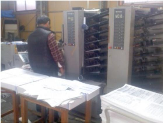
断裁した紙を機械に通し、1冊ずつ仕上げていきます。
